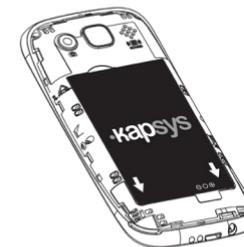
4. Enfin, replacez la coque arrière du téléphone en engageant d'abord la partie supérieure. Clipsez fermement sur les côtés pour refermer le téléphone
